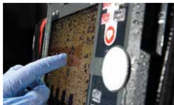
► TOUCH 'N' DIAL beim C3T : Bedienung über Dreh-/Drückrad oder wahlweise Touch.
